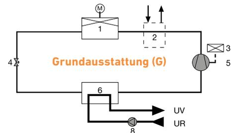
Diese Ausführung ist mit einer Pumpe und einem Wassertank ausgestattet. Sie ist zum direkten Anschluss an das Verbrauchernetz geeignet, z.B. für die Werkzeug- und Hydraulikkühlung einzelner Verbraucher.
